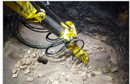
Přídavná lopata, vsunutá do nosiče kladiva
